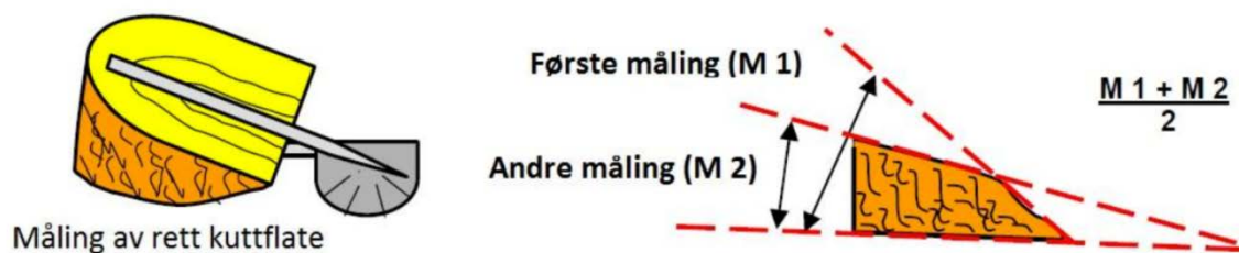
Figur 13: Måling av vinkel på styreskjær
